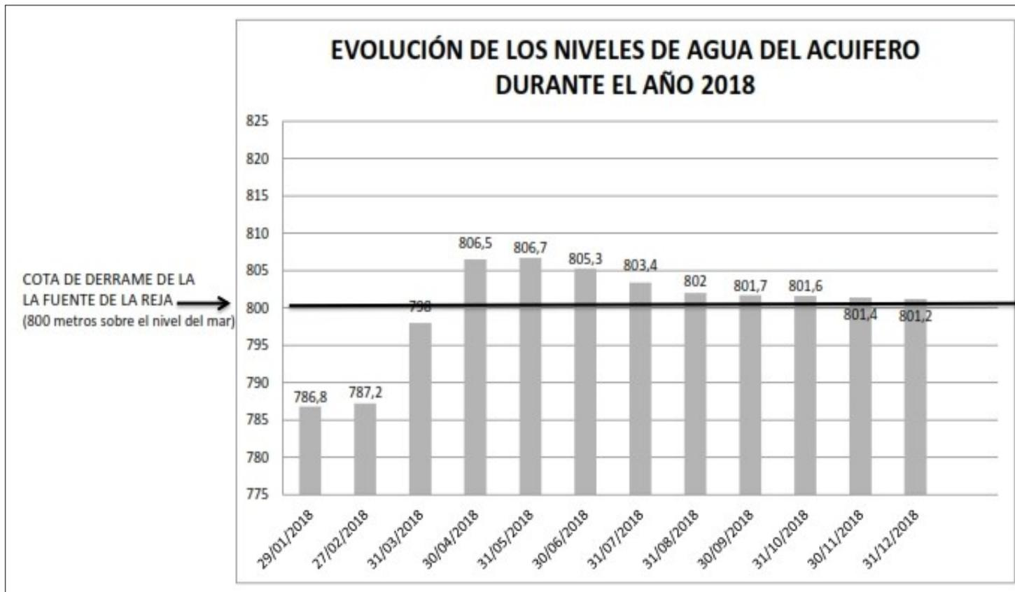
Como se ve en el gráfico, los niveles del agua del acuífero han descendido muy rápidamente. Actualmente estamos en el límite del derrame de la fuente. El nivel del acuífero estaba a finales de febrero en la cota 800,7 metros sobre el nivel del mar, según los datos que nos envía la Confederación Hidrográfica del Guadalquivir. El derrame de la fuente se produce entre la cota 800 y 801 metros sobre el nivel del mar.
